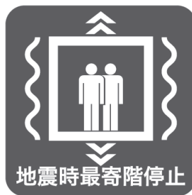
図 2.6.2 P波感知型 地震時管制運転装置
