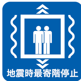
図 2.6.2 P 波感知型 地震時管制運転装置
