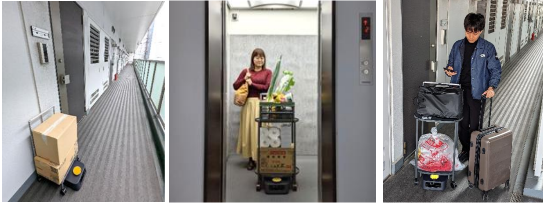
左：各部屋への宅配物の搬送 中：エレベーターと連携し、ロボットが住人の買い物荷物を部屋まで自律搬送 右：各部屋からロビーへの荷物運搬（ゴミ出しや旅行バック等）をサポート
