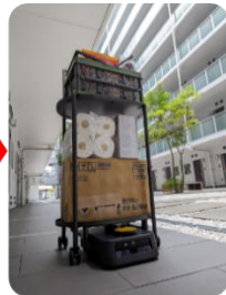
ロボットがカートを手荷物運搬しマンション内を移動
