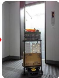
エレベーター連携により各階へ移動
