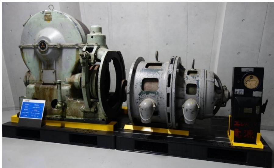
認定された「交流二段速度モータを用いたエレベーター用巻上機」 (左側：巻上機、中央：交流二段速度モータ、右側：電源部)
